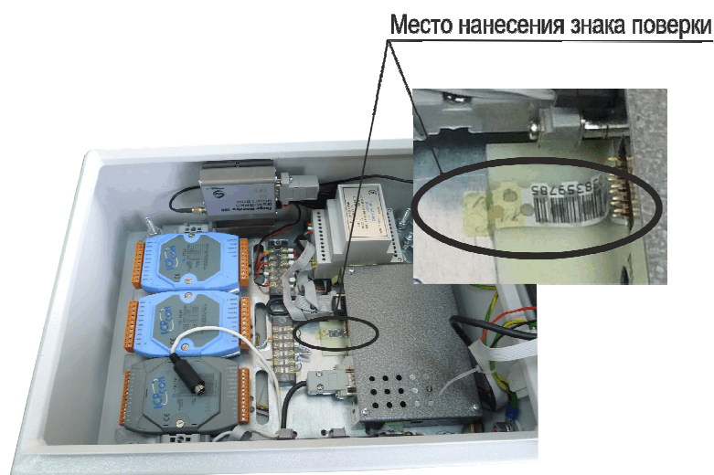
Рисунок 3 - Место нанесения знака поверки коммуникатора в металлическом шкафу
